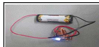
ジュールシーフ回路 LC発振で通常3V必要なLEDを乾電池1本で点灯
